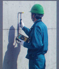
コンクリート面を軽く打撃するだけ
