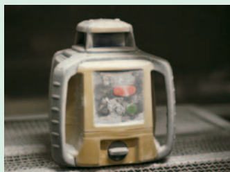
防塵テスト：JIS 保護等級 6 級 75 \mu m(0.075mm)のパウダー粉が内部に侵入しない
