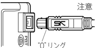
注意：左図のようにSK(USB)マークを本体のディスプレイ及び操作面側に合わせ、最後までしっかり取付けてください。取付けが不充分ですと防水性を損ない、故障の原因となります。
