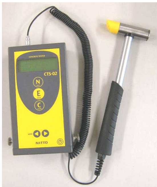
写真-3.2.1 CTS-02 接続状況
