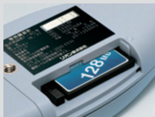
カードスロット部
